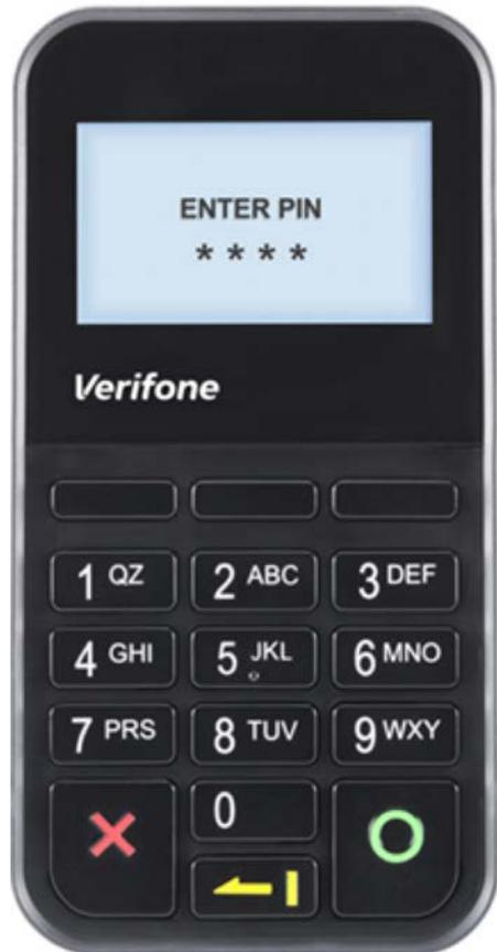
Дополнительное устройство, которое упрощает ввод пин-кода. Подключается непосредственно к POS-терминалам модели Verifone Vx520
